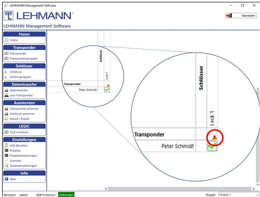
Abbildung: Warnhinweis bei fehlender Übertragung der LEGIC SAM an das RFID-System
